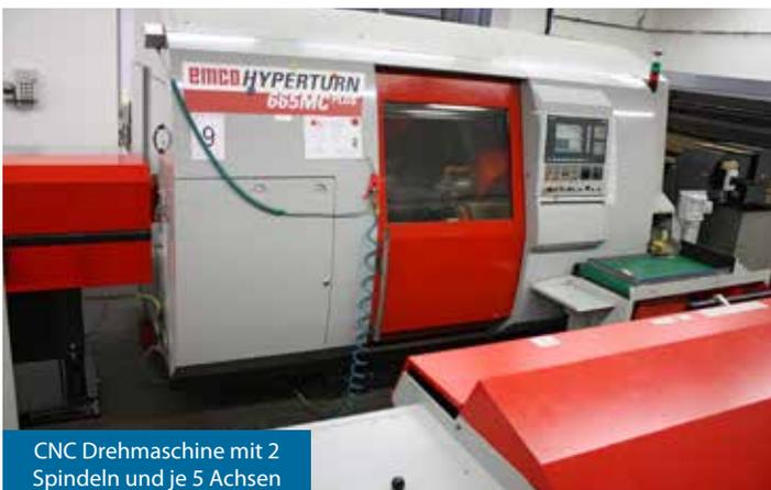
CNC Drehmaschine mit 2 Spindeln und je 5 Achsen
