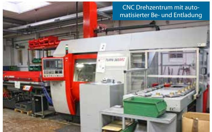
CNC Drehzentrum mit automatisierter Be- und Entladung
