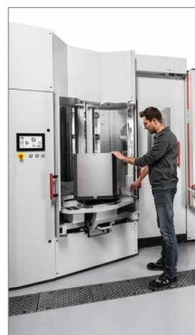
HS flex avec deux modules de magasin de palettes et poste d'équipement, adapté pour un centre d'usinage C 42 U.
